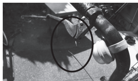
(写真)整備状況の悪い自転車。ブレーキのワイヤーが切れている。
